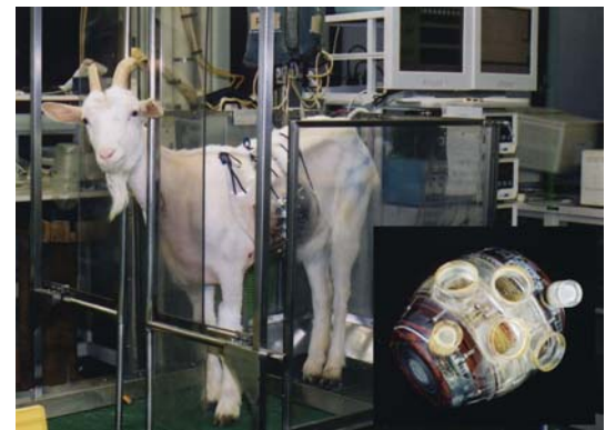
体内埋込式完全置換型人工心臓（波動型完全人工心臓）と 人工心臓装着ヤギ
