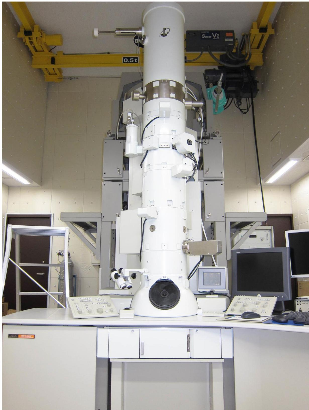
図1. 今回の研究に用いた超低温電子顕微鏡の写真（日本電子 JEM-3100FEF）
